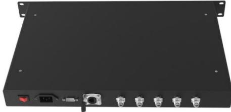
HG-ZF-GNB3361 是上海海积推出的北斗/GPS/GLONASS/伽利略卫星信号转发器，能接收室外 GNSS 信号，经滤波、放大、转发等环节，把室外天线接收到的有效 GNSS 信号转入室内，解决室内无法接收到 GNSS 信号的问题。经室内全向发射天线将 GNSS 信号进行发射，即可使信号在覆盖范围内的 GNSS 设备接收到卫星信号，实现实时定位等功能。
